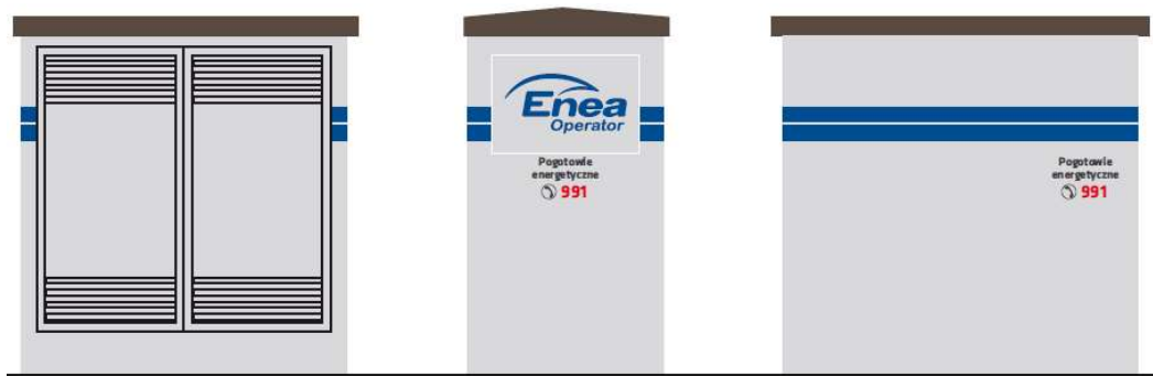
Rysunek nr 5. Kolorystyka złącza/szafy kablowej SN
